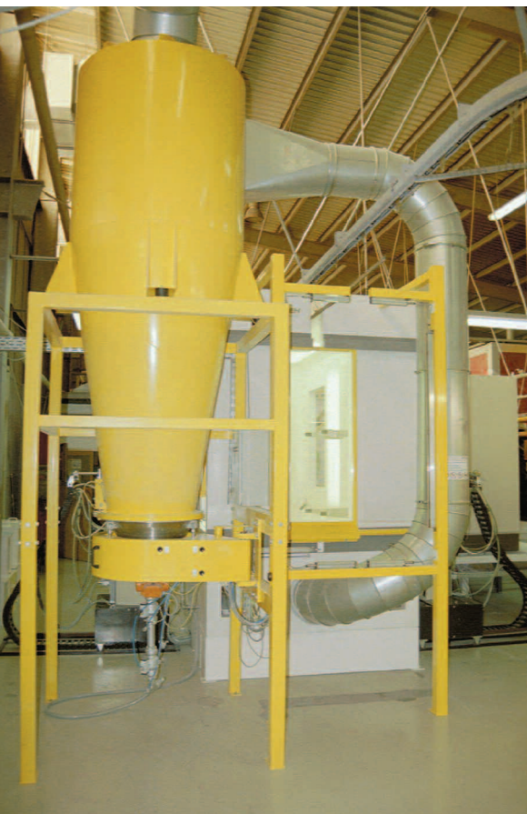
Die Kunststoffkabine mit pneumatischen Schiebetüren und Mono-Zyklon: Ein Farbwechsel dauert weniger als 15 Minuten
