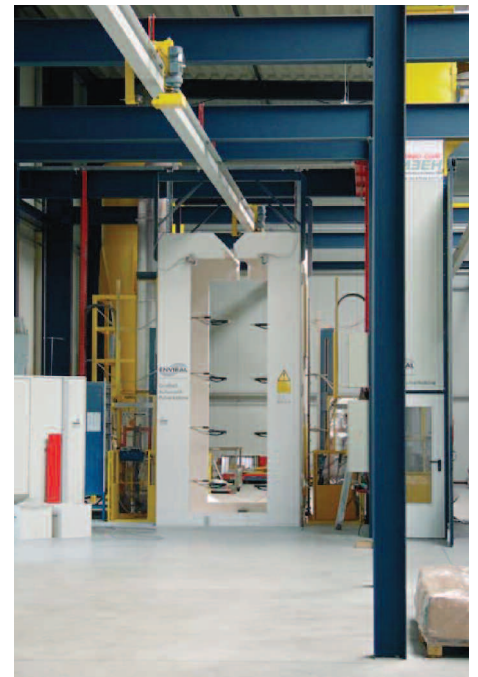
Die Automatikkabine für wirtschaftliches Beschichten der Großteile.
