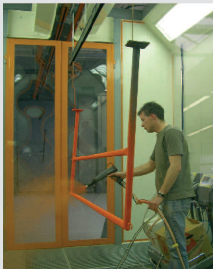
Die Beschichtung erfolgt von Hand und erzeugt nur wenig Abfallpulver
