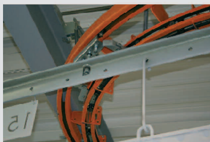
Die Fördertechnik ist eine Mischung aus Handschiebebahn und Power+Free-Technik
