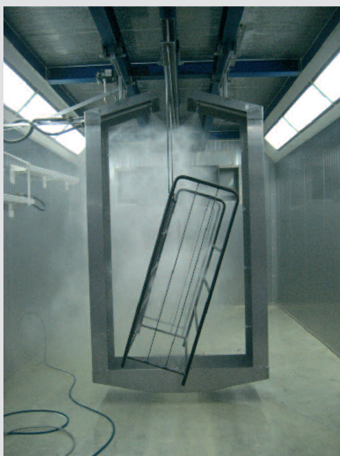
◀ Serien- und Kleinteile lassen sich automatisch mehrstufig vorbehandeln. Damit hat die Mattik GmbH ihr Kundenspektrum erheblich erweitert.
