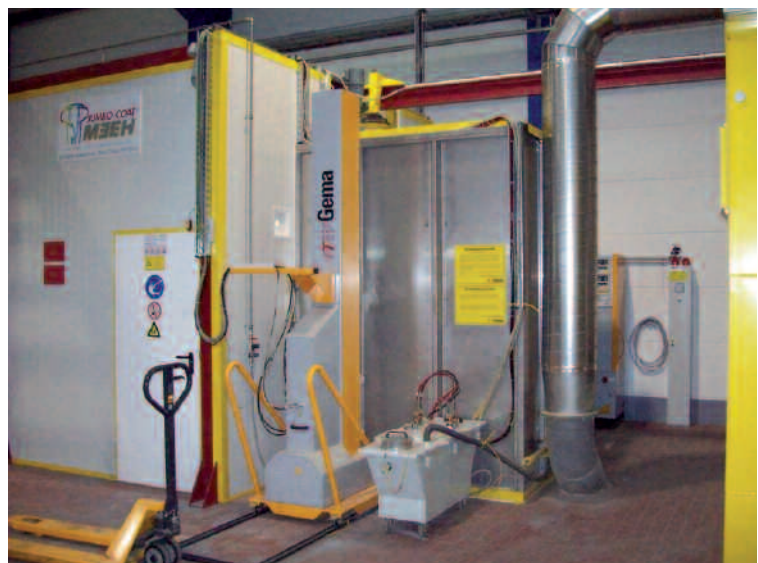
▲ Halbautomat2: Normalerweise Hansbeschichtung, für höchste Qualität von flachen grossflächigen Teilen steht die Auslaufschleuse mit Beschichtungsautomat zur Verfügung
